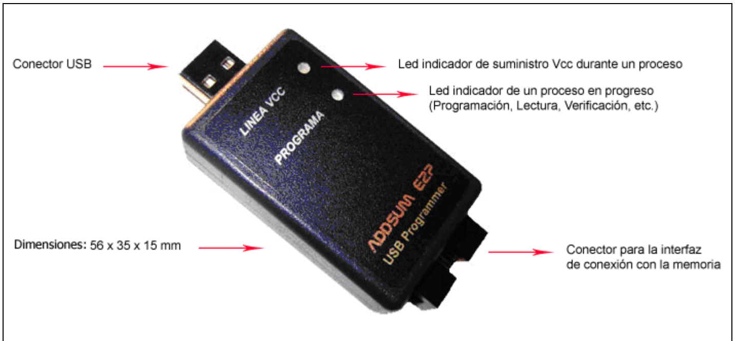
Figura 12 – Características del programador
